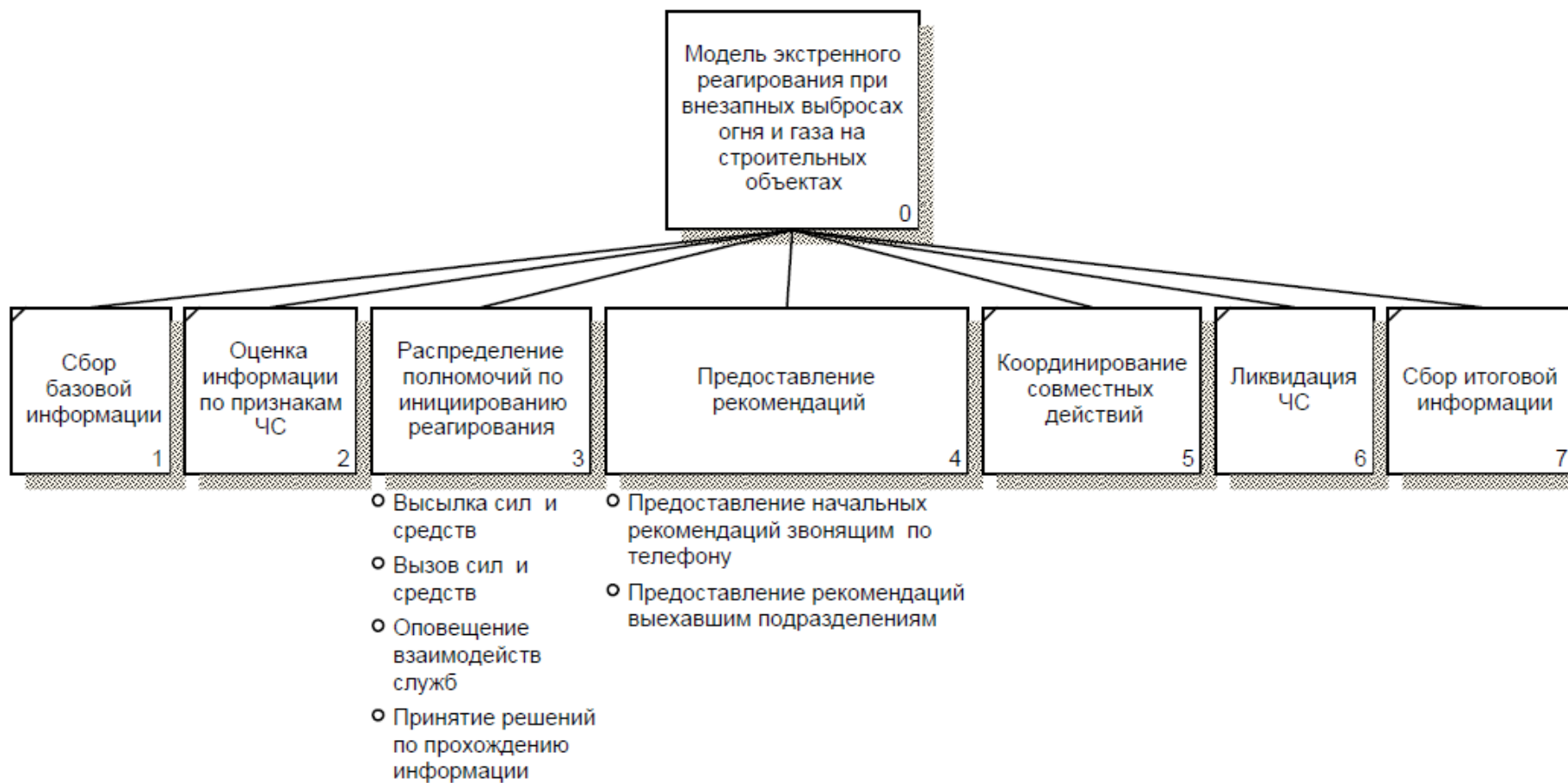
Рис. 3. Диаграмма дерева узлов функциональной модели процессов экстренного реагирования при внезапных выбросах газа и огня на строительных объектах
